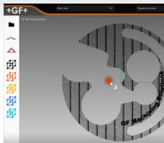
Werkzeugweg für Perlagedekoration, erstellt mit LaserCAM™
