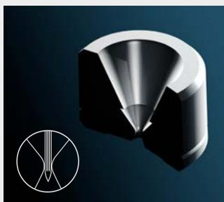
Afin de garder la position du fil stable et complètement supportée à l'intérieur du guide quand la machine est en mouvement, les guides diamant fermés offrent un jeu de seulement  $\pm 2 \mu\text{m}$  entre le fil et le guide.
